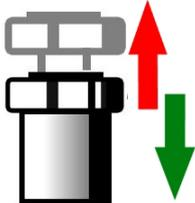
Paso 1: Aflojar el botón de ventilación y tirar hacia arriba hasta que se oiga claramente como el medio de servicio es soplado hacia el exterior.
