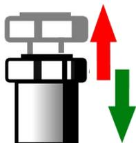
Schritt 1: Anlüftknopf lösen nach oben ziehen, bis ein deutliches Ausblasen des Betriebsmediums hörbar ist.
