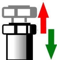
Étape 1 : Desserrer le bouton de levage et tirer vers le haut, jusqu'à entendre clairement le fluide être propulsé vers l'extérieur.
