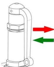
Schritt 1: Anlüftehebel von der Federhaube wegziehen, bis ein deutliches Ausblasen des Betriebsmediums hörbar ist.
