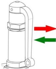
Paso 1: Tirar de la palanca de ventilación alejándola de la cubierta de muelle hasta que se oiga claramente como el medio de servicio es soplado hacia el exterior.
