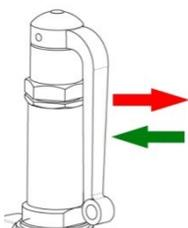
Шаг 1: Оттягивайте рычаг подрыва от пружинной крышки до тех пор, пока не услышите отчетливый шум выхода рабочей среды.
