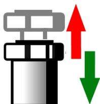
Шаг 1: Ослабьте и тяните кнопку подрыва вверх до тех пор, пока не услышите отчетливый шум выхода рабочей среды.
