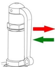
Étape 1 : Éloigner le levier du dispositif de levage du bonnet, jusqu'à entendre clairement le fluide être propulsé vers l'extérieur.
